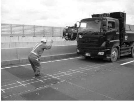
写真—2.4 第一実験（橋軸方向に移動載荷）
